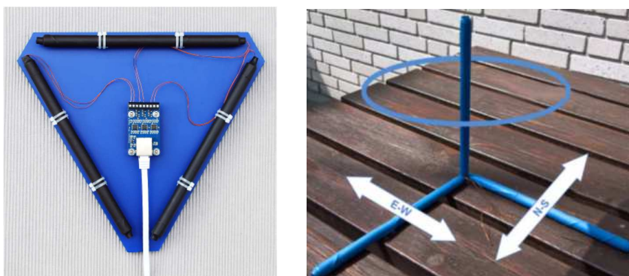
Rys. 3. Po prawej nieekranowane anteny ferrytowe z przedwzmacniaczem w układzie horyzontalnym, po lewej w układzie 3D z jedną anteną ustawioną pionowo [4]
