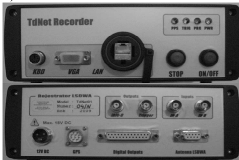
Rys. 2. Widok stacji pomiarowej umieszczonej na dachu Gmachu Elektrotechniki Wydziału Elektrycznego Politechniki Warszawskiej (a) oraz widok płyty czołowej i tylnej rejestratora (b).
