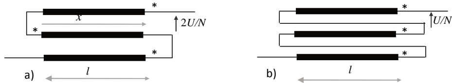
Rys.2. Uzwojenie trójwarstwowe jednorodne (a) i uzwojenie uzyskane w wyniku szeregowego połączenia trzech identycznych cewek (b)
