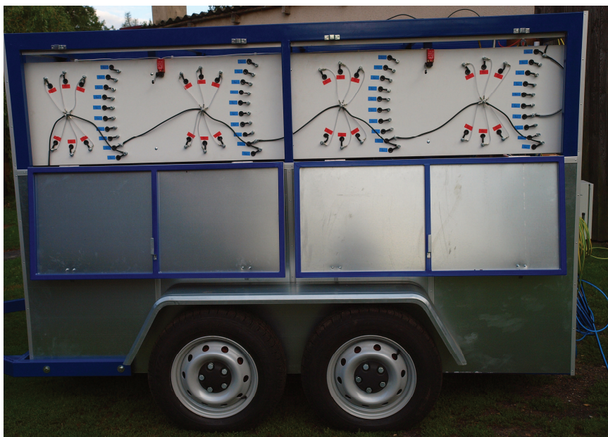
Rys. 4. Generator udarów długotrwałych GUP – 10/100
