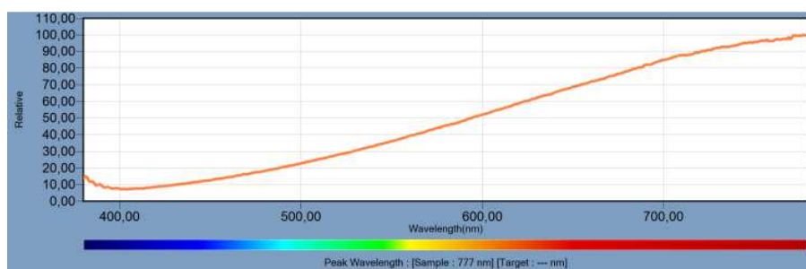
Rys. 3. Rozkład widmowy promieniowania żarówki halogenowej po upływie 180 sekund
