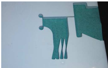
Rys. 5. Widok dodatkowych wyjść struny z materiału podczas kształtowania GRZEBIEŃ 2
