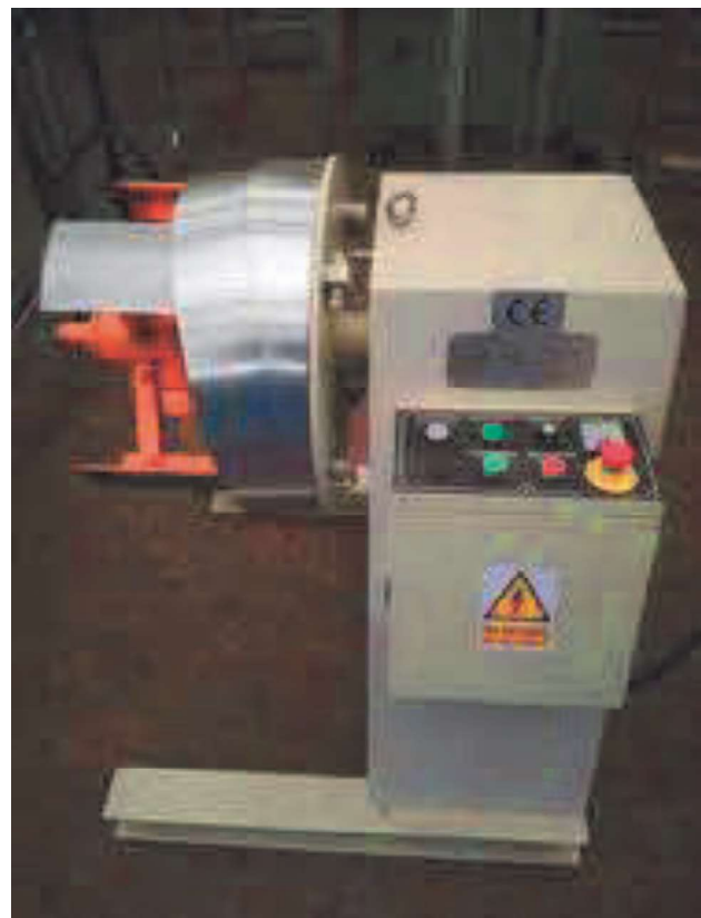
Rys. 6. Odwijak taśmy blachy stalowej z lokalnym pulpitem sterującym (źródło: własne)
