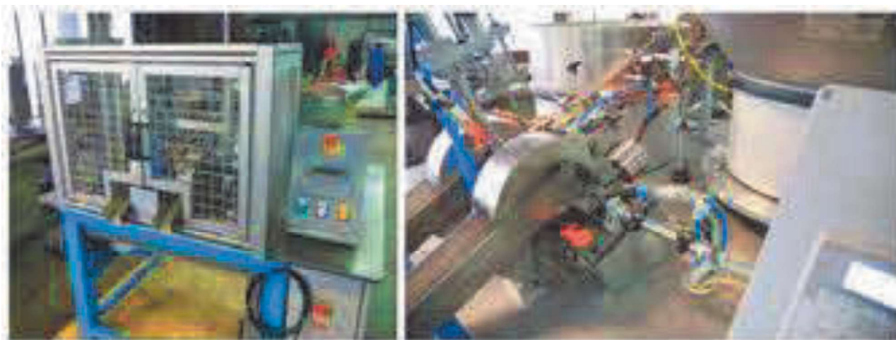
Rys. 9. Automat do montażu gwoździ papowych z podkładką. Po lewej: widok z przodu, po prawej: widok na strefę montażu (źródło: własne) Automatic machine for tar paper nail and washer assembly. Fig. 9. On the left: front view, on the right: view of the assembly zone (Source: own)
