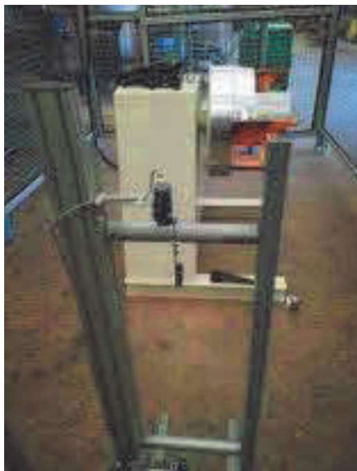
Rys. 7 . Bufor z czujnikami minimum-maksimum kontrolującymi ilość odwijanej taśmy stalowej (źródło: własne) Fig. 7. Buffer with minimum-maximum sensors for controlling the amount of unrolled steel tape (source: own)
