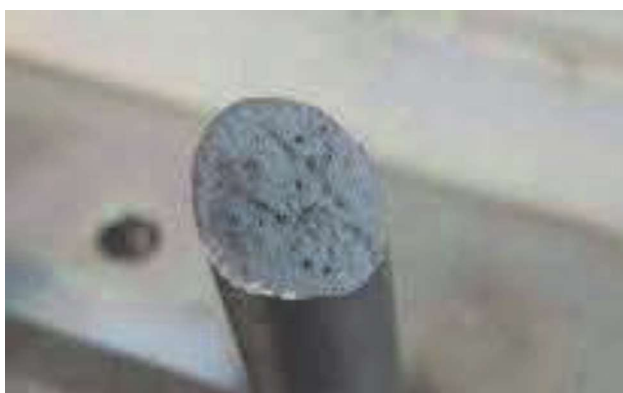
Fig. 10. Internal structure of the aluminum alloy Rys. 10. Struktura wewnętrzna odlewu aluminiowego
