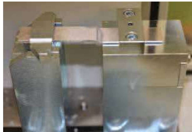
Fig. 4. Lap joint sample fixed in mounting bracket Rys. 4. Próbką zakładkowa w uchwycie mocującym
