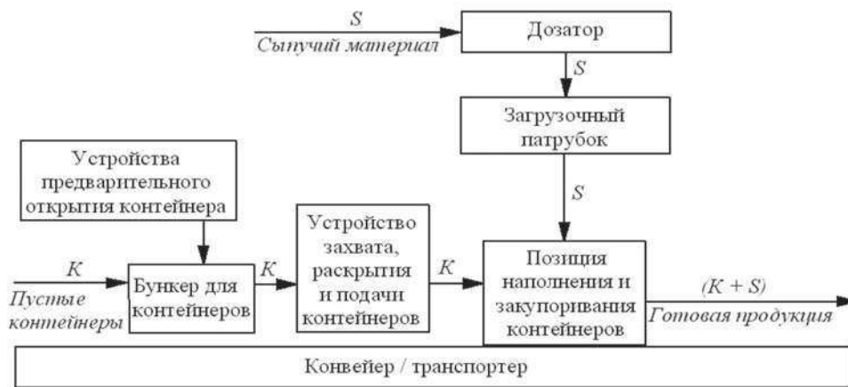
Рис. 1. Модульная схема построения расфасовочных комплексов Rys. 1. Modułowy schemat budowy opakowanie kompleksów Fig. 1. The modular diagram construction of filling complexes
