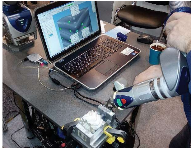
Рисунок 10. Контроль геометрии зубчатого колеса Fig. 10. Checking the geometry of the gear
