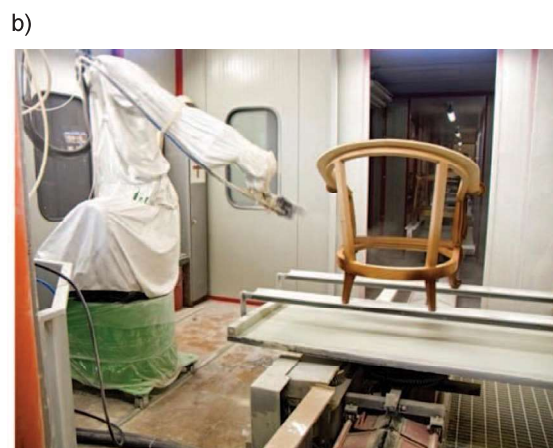
Rys. 2. Robotyzacja malowania natryskowego: a) przemysł samochodowy [14], b) przemysł meblarski [15] Fig. 2. Robotization of spray painting: a) car industry [14], b) furniture industry [15]
