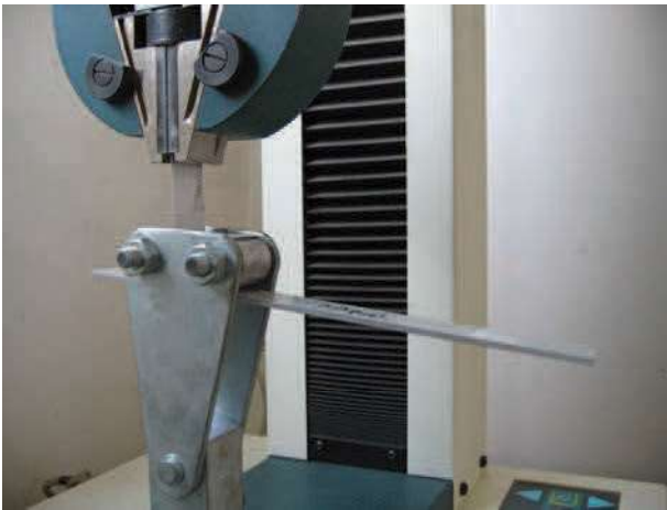
Rys. 4. Widok badanej próbki oraz przyrządu wymuszającego stan oddzierania Fig. 4. View of the specimen and the test stand for the peel test
