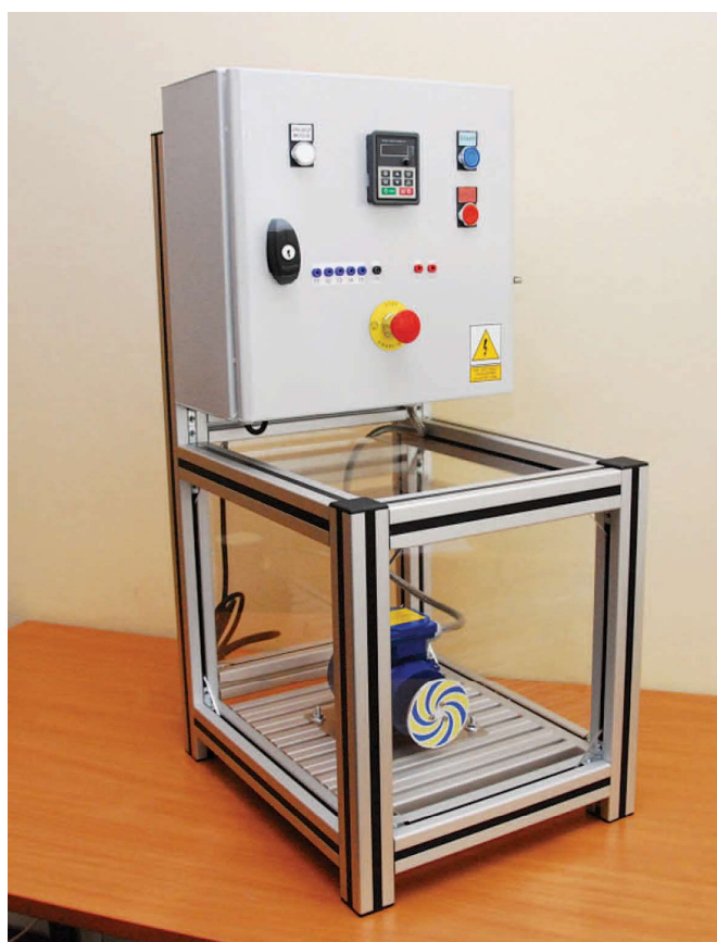
Rys. 6. Stanowisko z falownikiem Fig. 6. Stand with frequency converter
