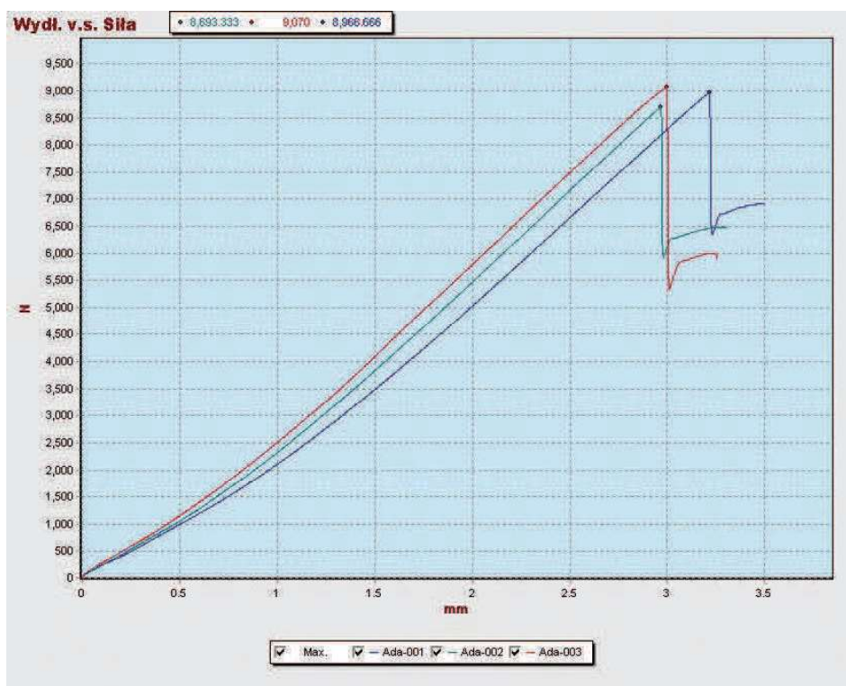
Rys. 3. Krzywe rozciągania próbek z połączeniem hybrydowym: a = 4 mm, c = 20 mm Fig. 3. Load-displacement curves for hybrid bonded specimens a = 4 mm, c = 20 mm
