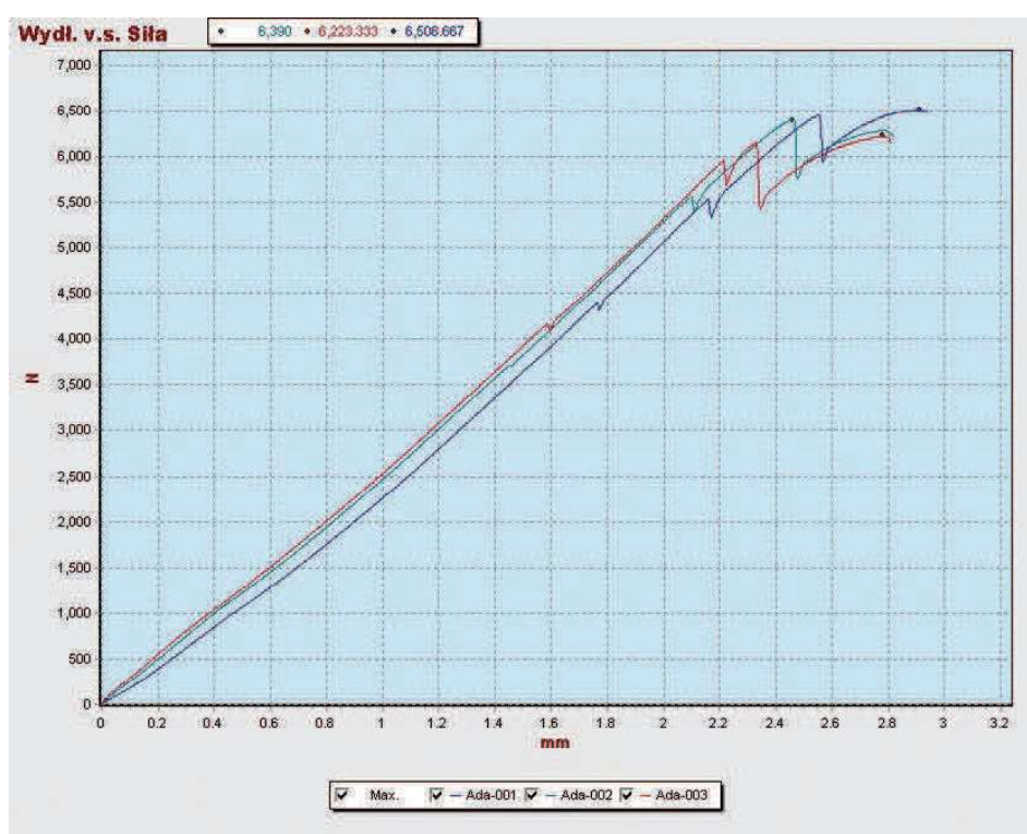
Rys. 2. Krzywe rozciągania próbek z połączeniem hybrydowym: a = 7 mm, c = 20 mm Fig. 2. Load-displacement curves for hybrid bonded specimens a = 7 mm, c = 20 mm
