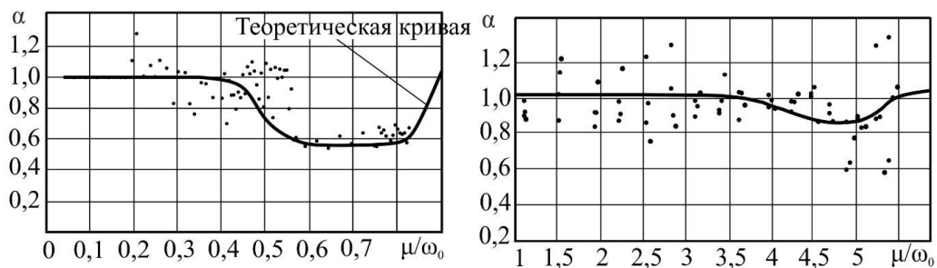
Рис. 7. Зависимость демпфирования \alpha от отношения \mu/\omega на диапазоне \mu/\omega \in [0,05, 6] Fig. 7. Damping factor \alpha as a \mu/\omega ratio function in the interval \mu/\omega \in [0,05, 6]
