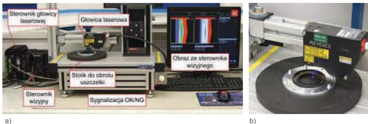
Rys. 6. Opracowane eksperymentalne stanowisko badawcze do kontroli uszczelniaczy wału: a) widok ogólny, b) zbliżenie na strefę pomiarową Fig. 6. The developed experimental test stand for the inspection of shaft seals: a) general view, b) close-up on the measurement area
