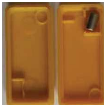
Rys. 2. Konstrukcja pływaka z podziałem komory w płaszczyźnie symetrii
