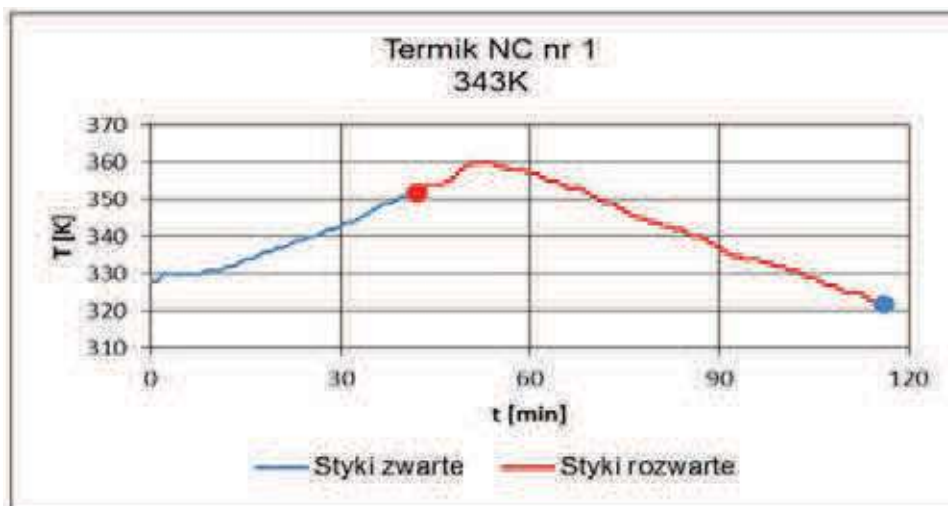
Rys. 10. Przykładowy przebieg zmienności temperatury oleju w czasie z zaznaczonymi wartościami, przy których nastąpiły zmiany stanu badanego wyłącznika termicznego o nominalnej temperaturze działania 343 K Fig. 10. An example of the course of oil temperature variability over time with the values indicated at which the state of the thermal switch under testing has changed with a nominal operating temperature of 343 K
