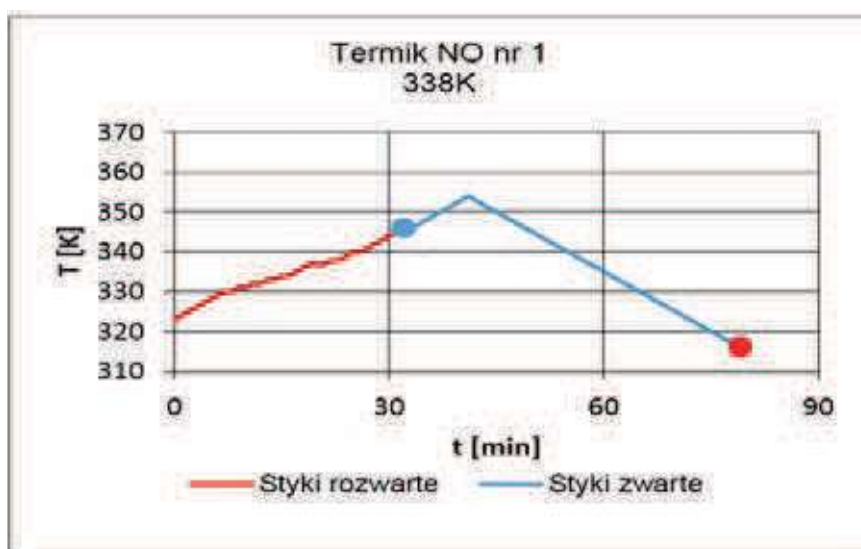
Rys. 9. Przykładowy przebieg zmienności temperatury oleju w czasie z zaznaczonymi wartościami, przy których nastąpiły zmiany stanu badanego wyłącznika termicznego o nominalnej temperaturze działania 338 K
