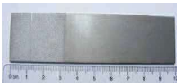
Rys. 1. Próbką po obróbce strumieniowo-ściernej Fig. 1. A sample after abrasive blasting
