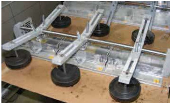
Rys. 2. Próbki umieszczone w przyrządzie do klejenia Fig. 2. Samples placed in the gluing instrument
