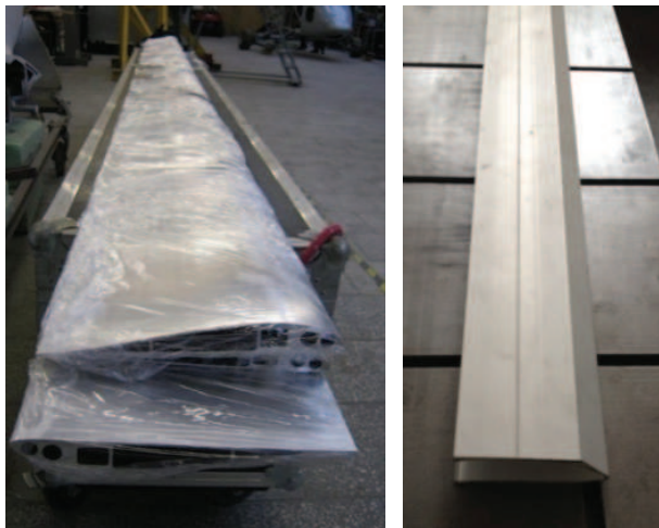
Rys. 1. Obiekty badań – duralowa łopata wirnika nośnego wiatrakowca (po lewej), kieszeń łopaty (po prawej)
