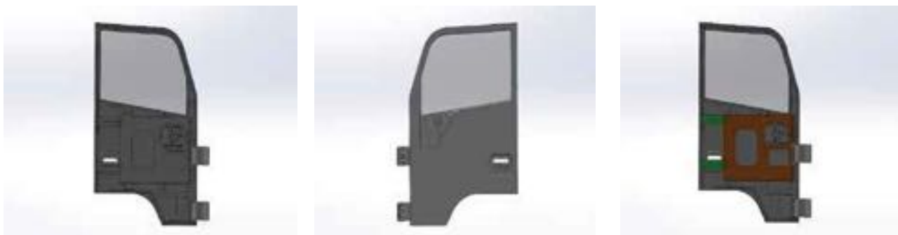
Fig. 2. Left doors of the N-Truck car and reinforce elements Rys.2. Drzwi lewe kabiny pojazdu N-Truck oraz element wzmacniające
