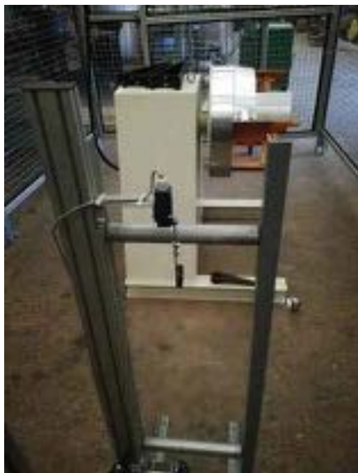
Rys. 7 . Bufor z czujnikami minimum-maksimum kontrolującymi ilość odwijanej taśmy stalowej (źródło: własne) Fig. 7. Buffer with minimum-maximum sensors for controlling the amount of unwound steel tape (source: own)
