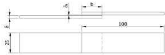
Fig. 2. Shape and dimensions of the test samples Rys. 2. Kształt i wymiary próbek stosowanych do badań.
