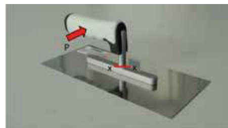
Fig. 4. A diagram for the load during a bending and torsion trial with the load parallel to the working Rys. 4. Schemat obciążenia podczas próby zginania ze skręcaniem przy obciążeniu skierowanym równoległe do płaszczyzny roboczej packi: P - siła obciążająca, x-x - przekrój uchwyty, w którym występują największe naprężenia zredukowane [2, 4]
