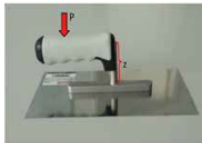
Fig. 3. A diagram of the load during a bending and compression trial with the load directed perpendicularly to the working surface of the trowel: P - load, z –the fragment of the handles with normal stress [2, 4]. Rys. 3. Schemat obciążenia podczas próby zginania ze ścisaniem przy obciążeniu skierowanym prostopadłe do płaszczyzny roboczej packi: P - siła obciążająca, z - fragment uchwyty, w którym występują naprężenia normalne [2, 4]
